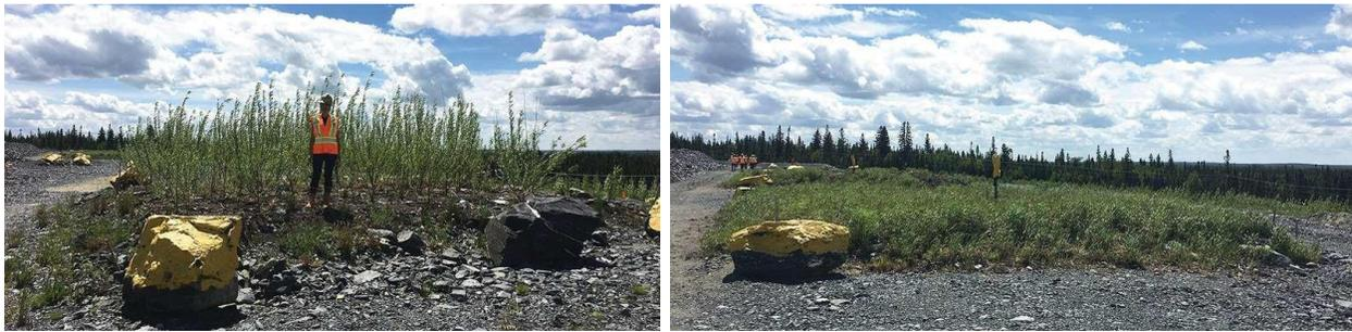
Figure 4 : Photos des 2 lysimètres in situ construits pour comparer le bilan hydrique de stériles recouvert d'une couche de sol avec a) des saules plantés et b) sans saule (Issues de Bussière et Guittonny, 2021b)
