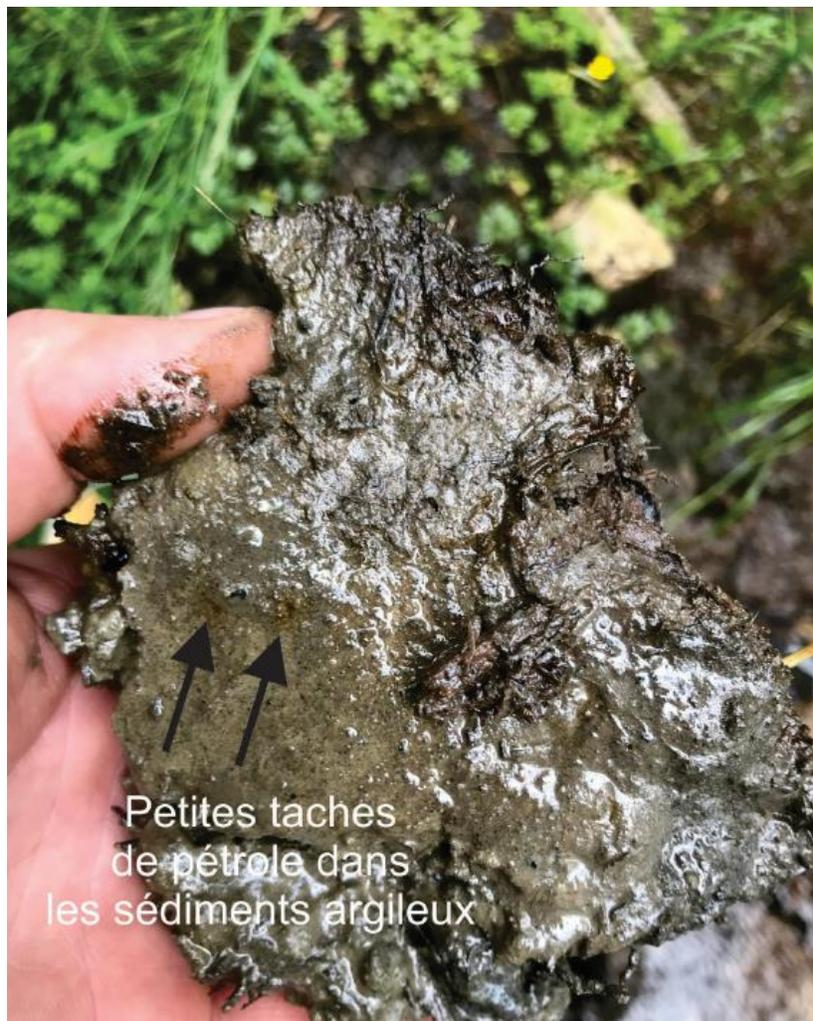
Figure 3 - Présence limitée de pétrole dans les sédiments argileux trouvée sur le site C036
