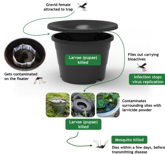
Figure 6. Fonctionnement du piège In2Care 468 .
