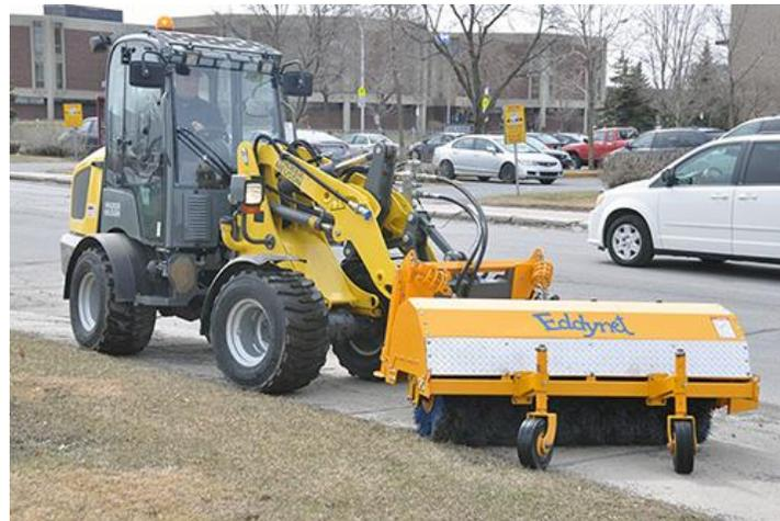
Figure 3-1 Tracteur articulé pour le nettoyage des trottoirs (Ville de Longueuil, 2017)
