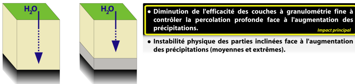
Figure 18 : Sources de risques pour les systèmes alternatifs de recouvrement face aux changements climatiques
