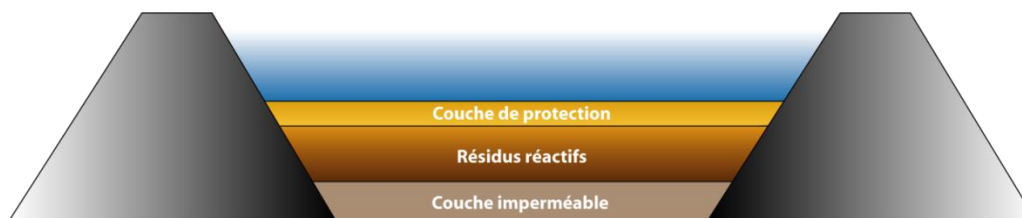
Figure 15 : Méthode de restauration du recouvrement en eau 11 (adaptée d'Aubertin et al. , 1999)
