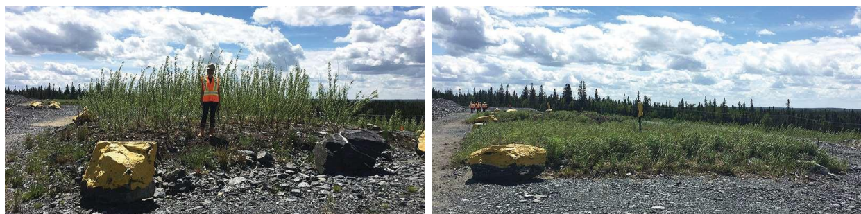
Figure 4 : Photos des 2 lysimètres in situ construits pour comparer le bilan hydrique de stériles recouvert d'une couche de sol avec a) des saules plantés et b) sans saule (Issues de Bussière et Guitttonny, 2021b)
