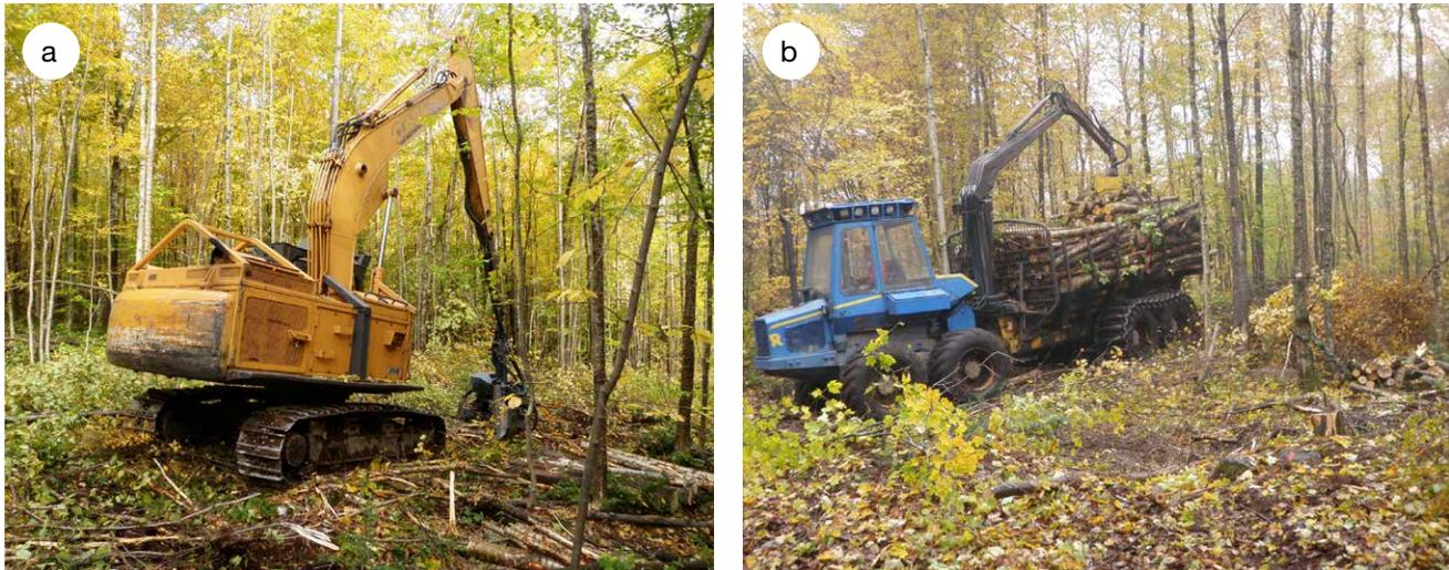
**Figure 1.** Équipements utilisés pour la récolte : a) abatteuse multifonctionnelle pour l'abattage; b) porteur forestier pour le débardage (Photos : F. Guillemette).
