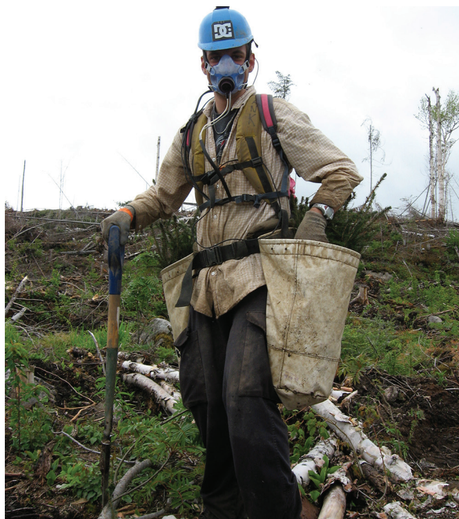
Travailleur portant un appareil de mesure de la consommation d'oxygène pendant son travail. DRF.
