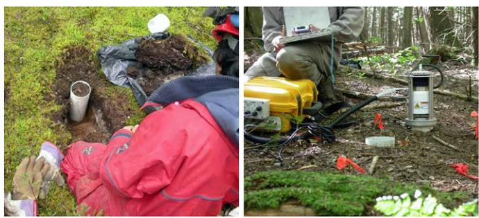
Figure 2. À gauche, transplantation d'une carotte de sol; à droite, un analyseur de gaz à infrarouge portatif (Licor-8100) qui mesure la Rh.
