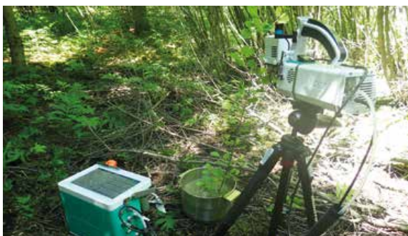
Figure 2. Outil portable de mesure de photosynthèse évaluant simultanément les échanges gazeux photosynthétiques et la fluorescence de la chlorophylle, ce qui permet de mieux comprendre la physiologie, illustré ici avec une branche de nerprun bourdaine
