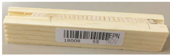
Carotte de bois de 5 mm de diamètre, prise à 1 m de hauteur, sablée et collée sur un support pour être analysée. Le code à barres permet de connaître la provenance de l'échantillon.
