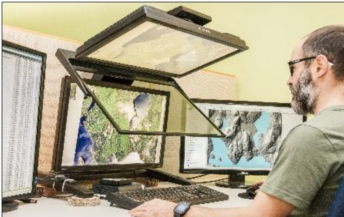
Figure 22. Photo-interprétation 3D bonifiée par le lidar
