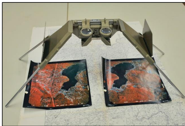
Figure 8. Stéréoscope, utilisé pour visualiser les photos aériennes en 3D, pour délimiter et caractériser les peuplements forestiers
