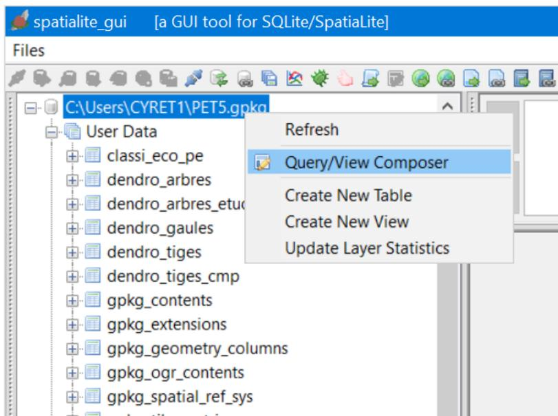
L'ouverture du créateur de requête fait apparaître la fenêtre présentée à la figure 29. Cette figure présente un exemple de définition des paramètres d'une requête dans l'onglet « *Main* ». Tout en haut, on remarque le code SQL de la requête définie, mais l'outil crée lui-même ce code en fonction des
