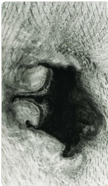
Nœud avec inclusion d'écorce : découpe à 6,5 cm de la surface de la déformation illustrée à la fig. 29. Une telle déformation ne peut pas être incluse dans les débits.
