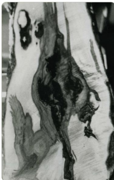
Figure 71 — Renflement du pied : débits et réduction de volume
