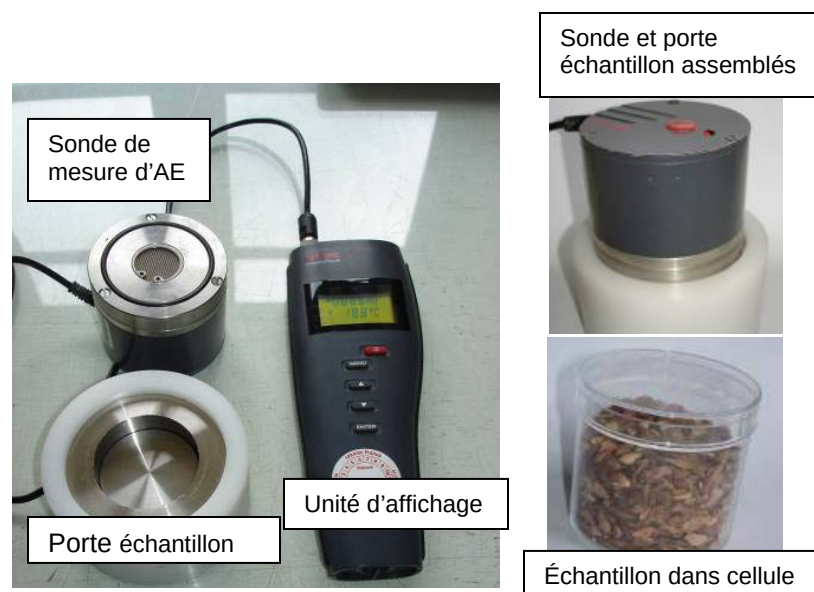
Figure 3 : Mesure d'activité de l'eau de routine avec un appareil portatif. Les échantillons, stabilisés à la température de mesure dans les cellules, sont placés dans le porte échantillon. Le couvercle de la cellule est enlevé. La valeur d'AE est obtenue rapidement. (Photos P. Baldet).
