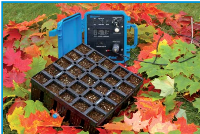
Figure 2. Mesure de la teneur en eau du substrat en temps réel à l'aide du MP-917 (ESI Environmental Sensors inc., Victoria CB, Canada) (Photo : Mohammed S. Lamhamedi et Mario Renaud, DRF, MRNF).
