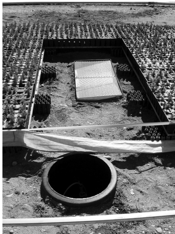
Figure 3. Capteur conçu par la DRF pour mesurer le lessivage saisonnier des engrais sous les plants en récipients.
