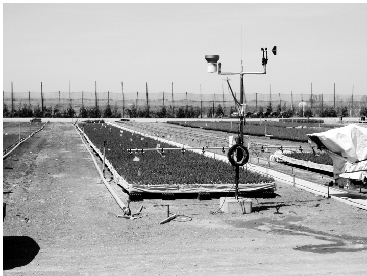
Figure 4 : Station météorologique permettant de mesurer de façon continue les variables environnementales dans le dispositif d'épinette blanche 2 + 0 produite dans le récipient 25-350A à la pépinière forestière de Saint-Modeste en 2002.
