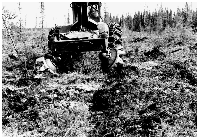
Figure 6. Préparation mécanique du sol par scarifiage à disques, sur une station à éricacées
