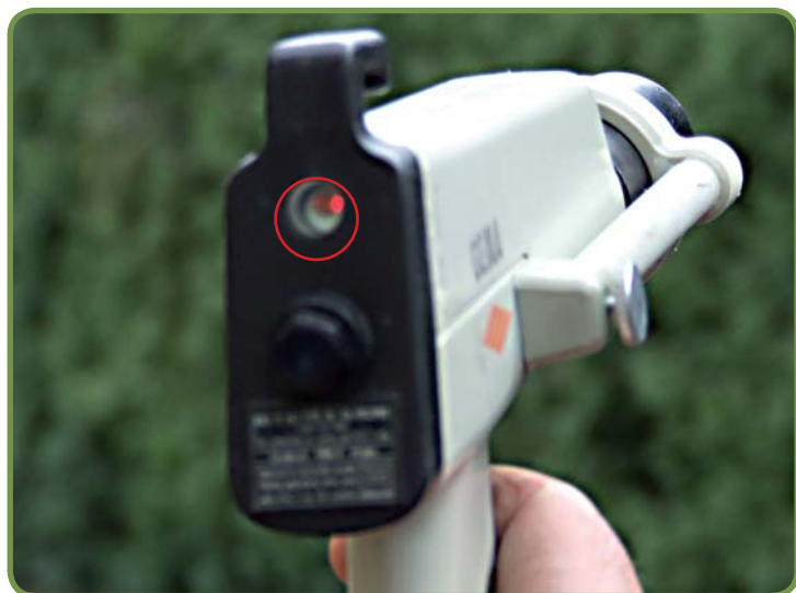
Figure 9. En pressant la gachette, le voyant lumineux rouge assure du bon fonctionnement de l'appareil.
