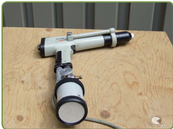
Figure 1. Pistolet électrostatique monté avec toutes ses composantes de base.
