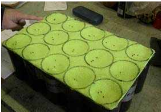
Figure 1. Récipient 15-320 recouvert de polar jaune utilisé pour le dénombrement des semences dans les cavités lors des ensemencements
