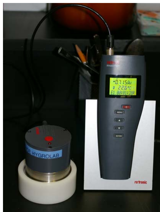
Hygromètre et sonde de mesure pour l'activité de l'eau (les semences sont déposées dans la base de la sonde à gauche) Photo Fabienne Colas
