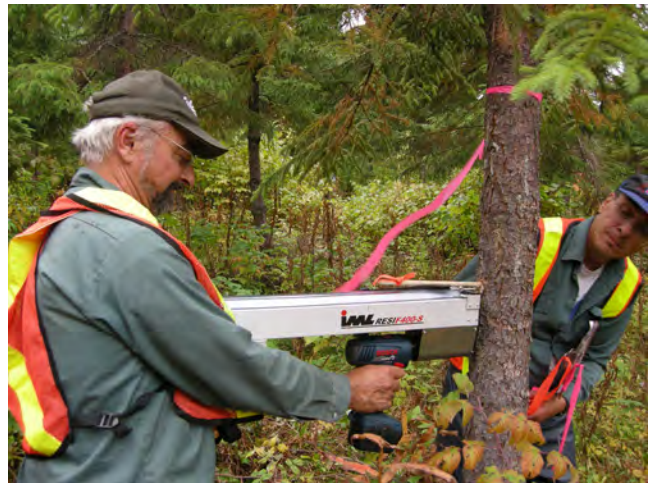
Évaluation de la densité du bois à l'aide du résistographe dans un test d'épinette noire (G. Lapointe)
