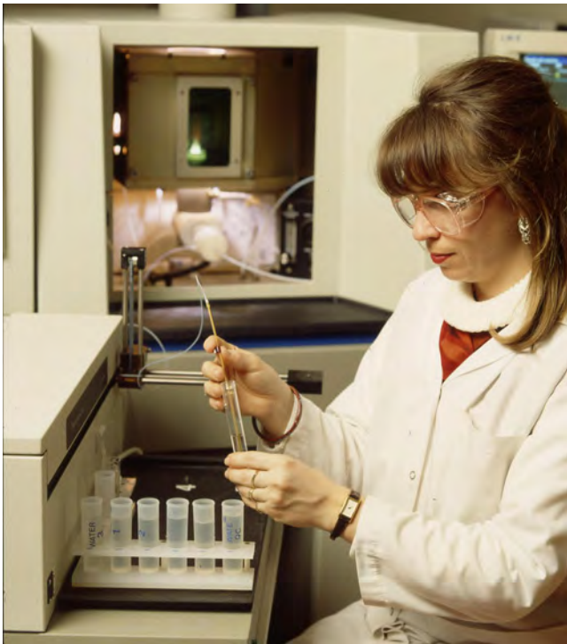
Analyse des tissus végétaux par spectrométrie d'émission atomique au plasma par Martine Beaumont, technicienne au laboratoire.
