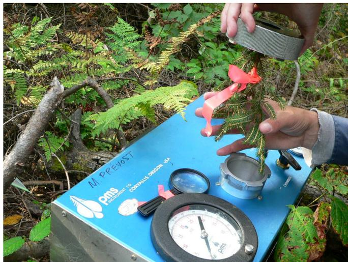
Photo 2. Mesure du potentiel hydrique du xylème sur une branche d'épinette rouge à l'aide d'une chambre à pression (Photo : D. Dumais, MFFP).
