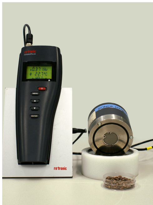
Figure 2. Mesure de l'activité de l'eau avec un hygromètre spécialisé. Le résultat est obtenu en quelques minutes seulement (Photo : F. Colas, MRN).
