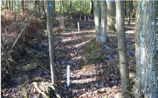
Un total de 180 tuyaux de plastique ont été perforés et insérés 100 cm dans le sol afin de mesurer le niveau de la nappe phréatique dans l'ensemble du dispositif et de le relier au développement de la biomasse en régénération (Photo : M. Prévost).
