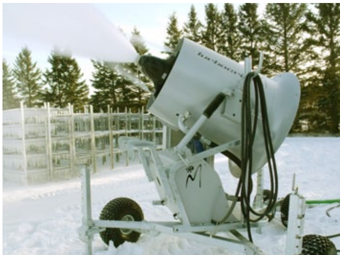
Figure 2. Fabrication de la neige artificielle en pépinière forestière lorsque les chutes de neige sont tardives ou que l'épaisseur de neige est insuffisante pour assurer une protection accrue des plants contre le gel hivernal.
