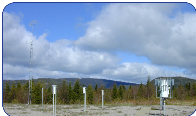
Échantillonnage des sources de nutriments dans les précipitations.
