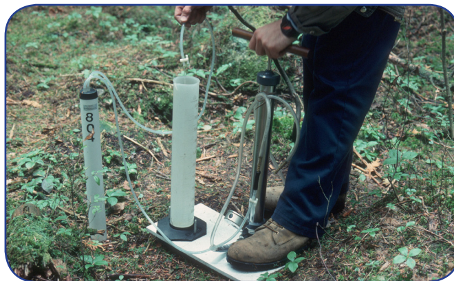
Échantillonnage des éléments nutritifs dans la solution de sol sous la zone racinaire.
