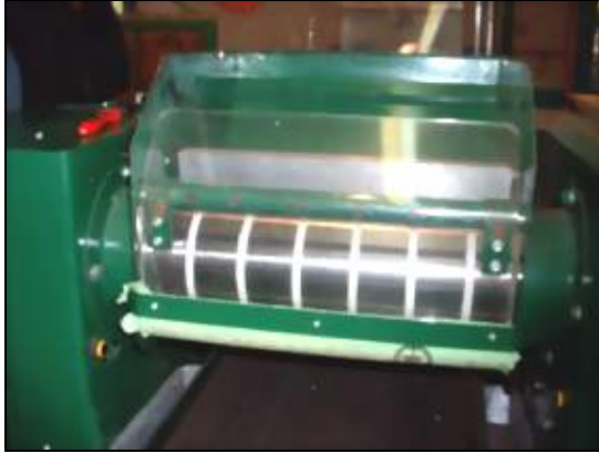
Photo 2 : Rouleau semoir à trois trous pour le récipient 36-200 dont une rangée de trous est bouché à l'aide de ruban correcteur.
