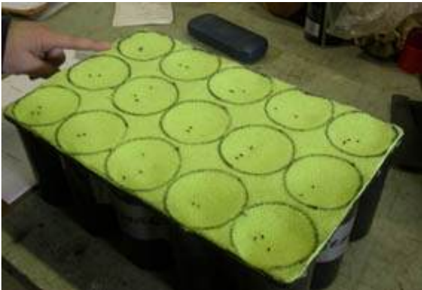
Photo 1 : Récipient 15-320 recouvert de polar jaune utilisé pour le dénombrement des semences dans les cavités lors de l'ajustement du semoir
