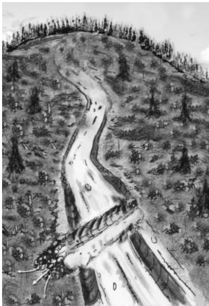
Figure 3.2 - Digue de déviation
